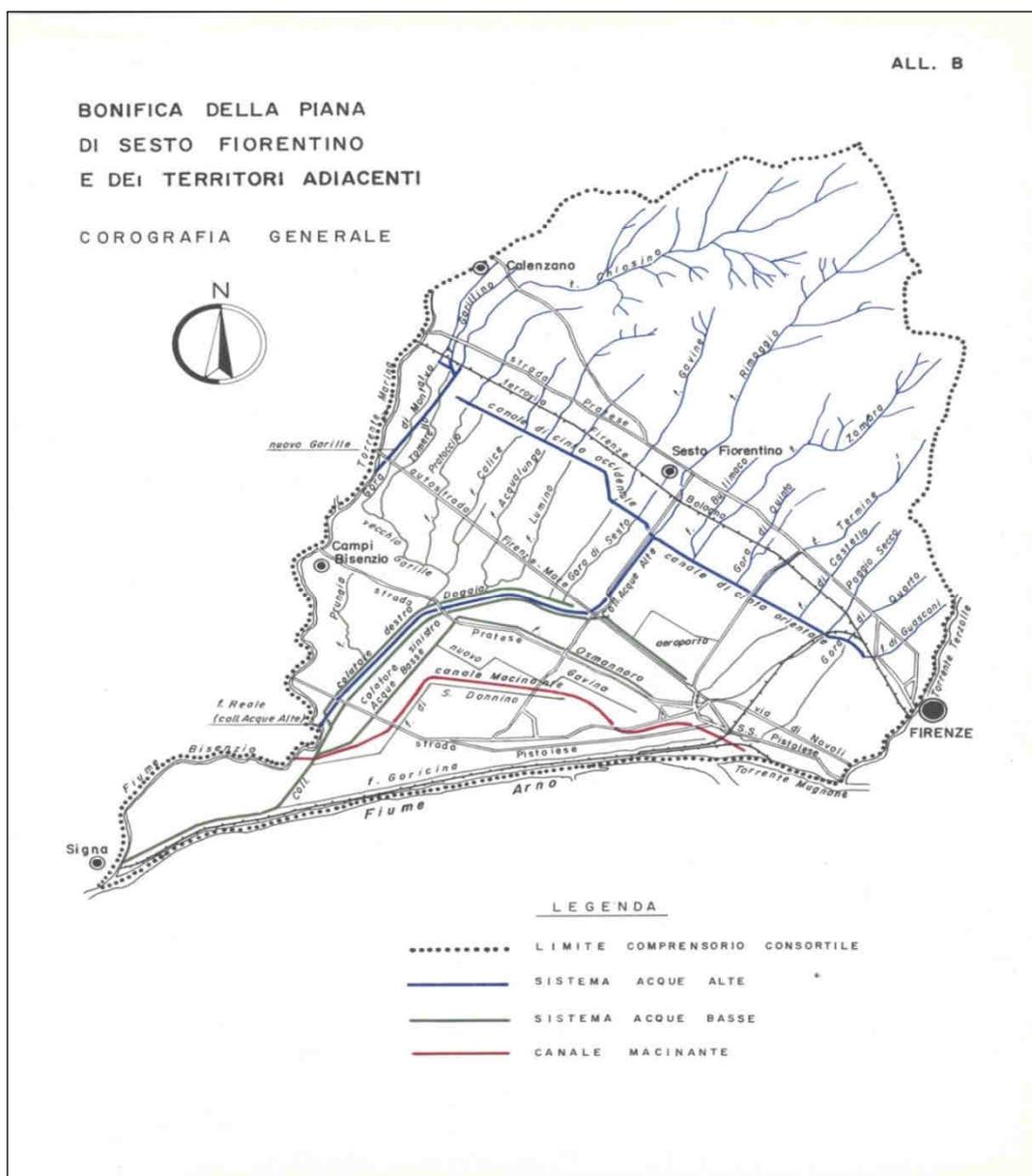
**Figura 2.3:** Corografia del Comprensorio in cui viene evidenziata la distinzione tra i sistemi di acque alte e di acque basse.
